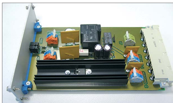
Bild 1: Ansicht der Notstromanschluschkarte (NAK) mit Frontplatte und Steckerleiste
