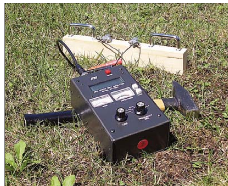
Bild 6: An die Erdspieße wird eine Impedanzmessbrücke angeschlossen. Blind- und Wirkwiderstand werden dann über einen breiteren Frequenzbereich in etwa 2-MHz-Schritten gemessen. Fotos: OE5CWL
