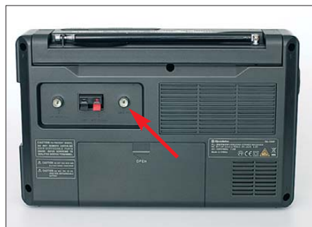
Bild 2: Rückseite des Roadstar TRA-2350P mit ZF-Ausgangsbuchse (siehe Pfeil)
