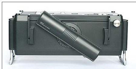
Auf der Oberseite des Empfängers ist in einem Gehäuse eine Ferritstabantenne für Lang- und Mittelwelle drehbar angebracht.
