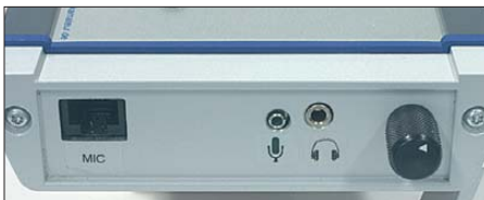
Bild 7: An der rechten Seite kann entweder ein Mikrofon mit Westernstecker (Icom HM-103, Yaesu MH31A8J o. a.) oder eine Hör-/Sprechgarnitur bzw. ein Lautsprechermikrofon (z. B. Wimo MS-109) angeschlossen werden.
