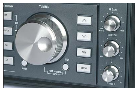
Für Suchempfang dient ein samtweich laufender VFO-Knopf.
