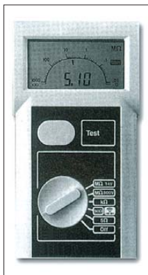
Bild 12: Negatives Beispiel zur Reiz-Reiz-Kompatibilität: Die Skala dieses Ohmmeters ist inkompatibel ausgelegt. Die Darstellung der Widerstandswerte erfolgt entgegen dem Uhrzeigersinn. Das erschwert das Erkennen der Messwerte, woraus längere Bearbeitungszeiten resultieren.
