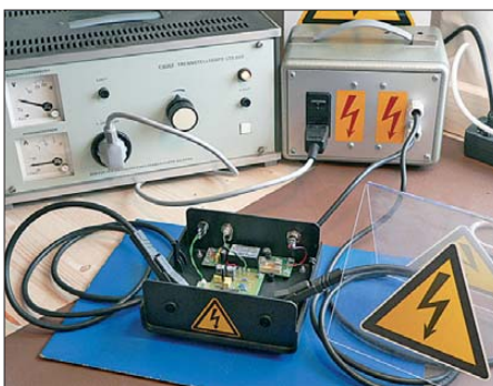
Bild 11: Während der Probephase wurden die Teilerketten auf der UAP26 mit Spannungen von 2000 V getestet. Für den Regelbetrieb sollten die gemessenen Spannungen bei maximal 500 V liegen. Fotos: DG9WF
