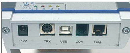
Bild 6: An der linken Seite befinden sich die wichtigsten Buchsen, v.l.n.r. Stromversorgung, Transceiver, USB zum PC (Repeater-Tabelle laden, Chat), RS232 für GPS-Maus, PIC-Programmierung (für evtl. Updates).
